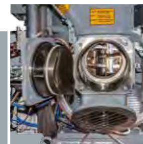
Auslauf mit Reinigungsklappe Discharge with cleaning cover
