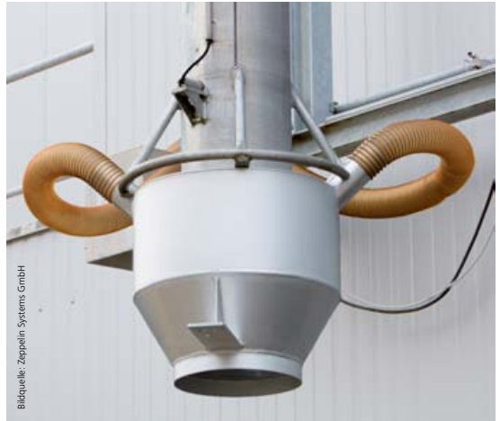
Im Siebter FVS wird das Granulat nur durch Schwerkraft beschleunigt, in einem Ringspalt dispergiert und durch einen Gasstrom gereinigt.
