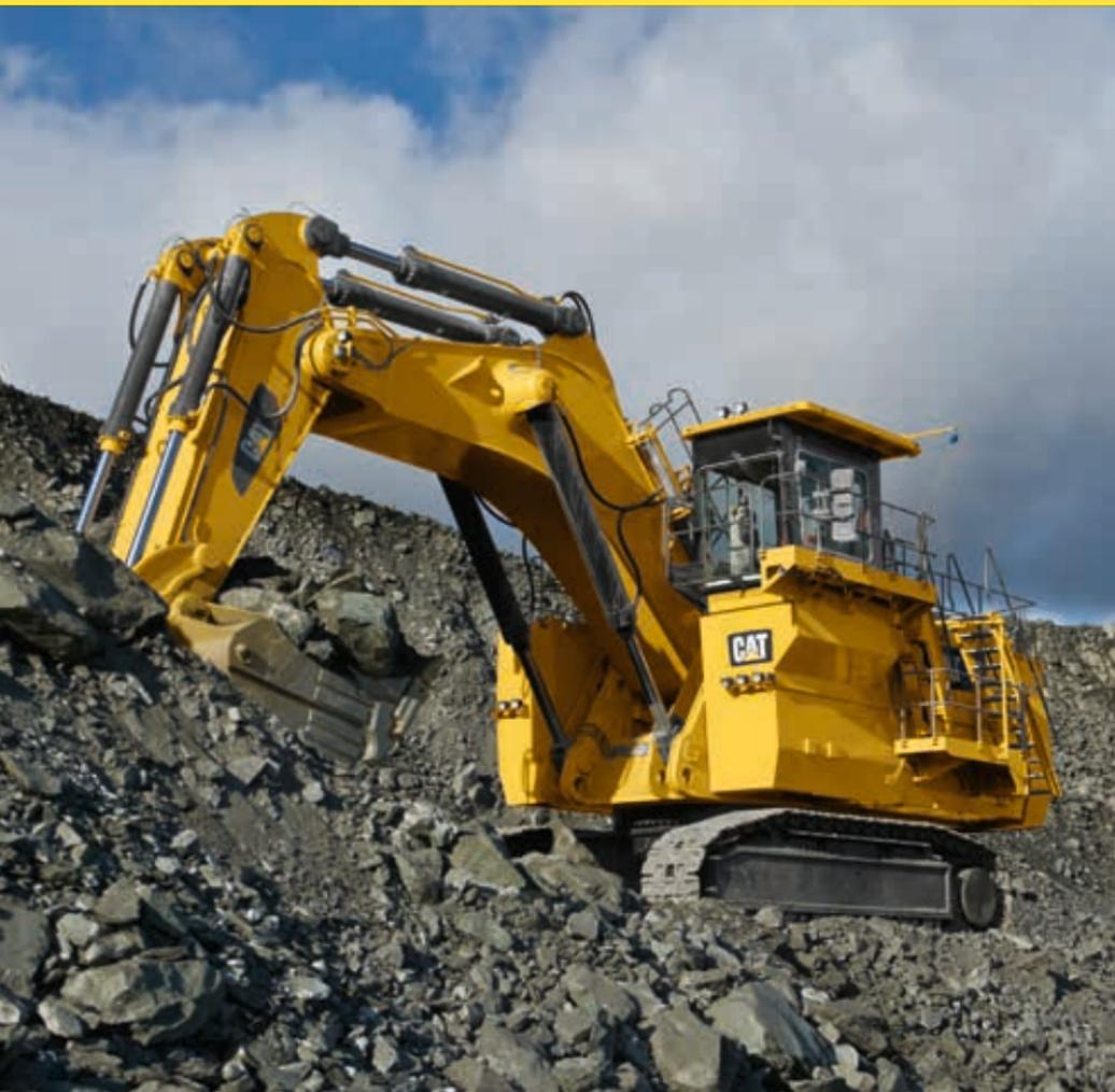
Zeppelin verfügt über eine fein abgestufte Produktreihe leistungsstarker und technologisch führender Großhydraulikbagger in Tieflöffel- oder Ladeschaufelausführung. Die Typen Cat 6030 AC und Cat 6040 AC sind auch mit Elektroantrieb verfügbar.
