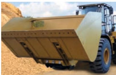
*Schaufelintegriertes Kamerasystem nach ISO 5006*
