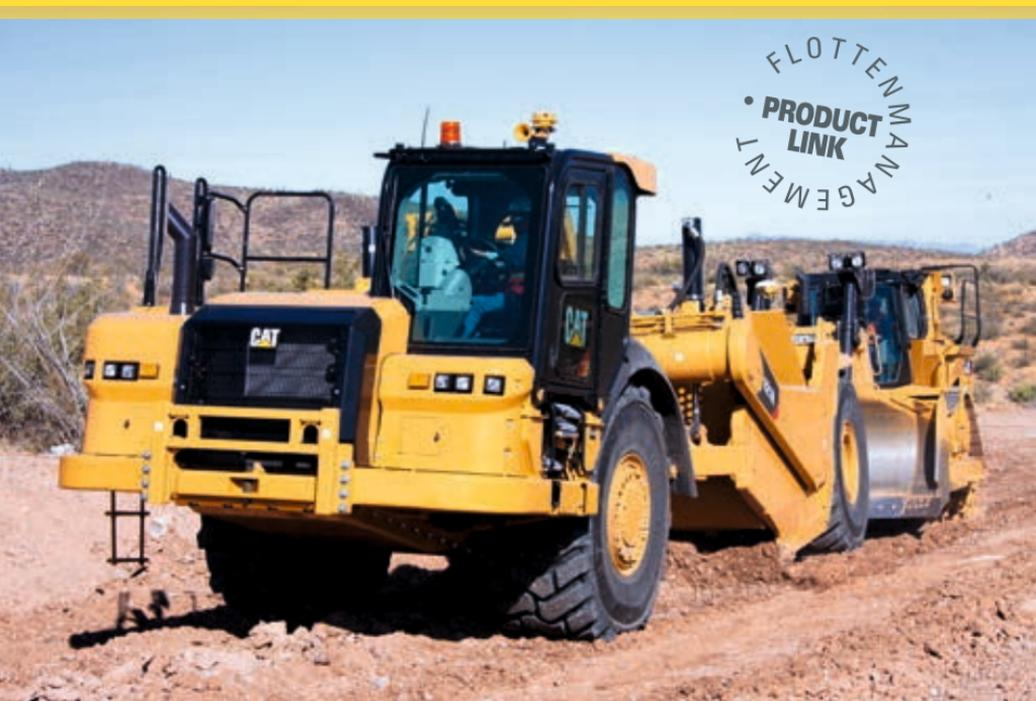
Schürfzüge, früher bei großen Erdbewegungen oft die dominierenden Baumaschinen, werden heute in Deutschland kaum noch eingesetzt. Dennoch bilden diese Maschinen, passende Einsatzbedingungen vorausgesetzt, die leistungsstärksten und effektivsten Systeme in der schweren Erdbewegung.
