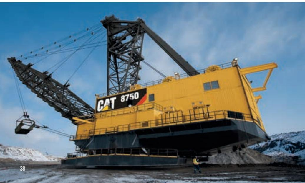
Deshalb müssen die Bagger extrem robust gebaut werden, um diesen Belastungen im 365-Tage-Betrieb rund um die Uhr dauerhaft standhalten zu können. Die Bagger be-laden keine Muldenkipper, sondern schütten den Abraum auf der bereits bearbeiteten Tagebauseite ab. Dies ist nur mit überlangen Auslegern möglich. Auf diese Weise legen sie im „Direktversturz“ wertvolle Rohstoffe frei, die dann von Baggern und Radladern abgetragen und von Muldenkippern aus dem Tagebau befördert werden.
