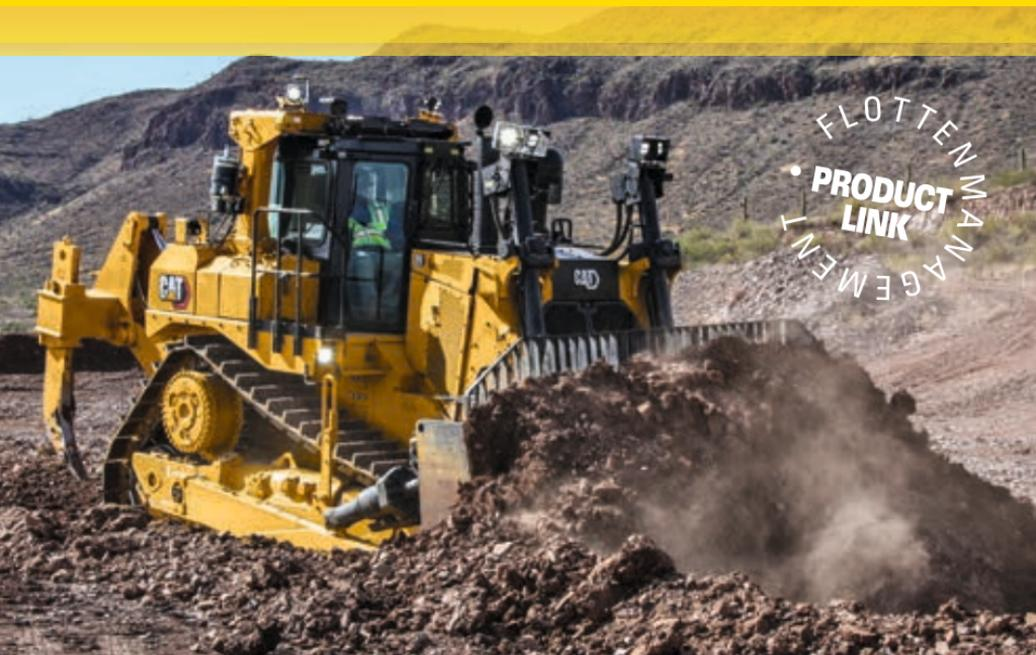
Typisches Merkmal der Cat Kettendozer ab 17 Tonnen ist der Delta-Antrieb mit hochgesetztem Antriebsrad, das über dem Schmutzbereich ohne Stoß- und Seitenbelastung arbeitet – die Antriebsselemente und die ölgeschmierten Ketten leben dadurch viel länger. Der hydrodynamische Fahrtrieb mit Wandler und Lastschaltgetriebe erreicht einen deutlich besseren Wirkungsgrad als andere Konstruktionen.
