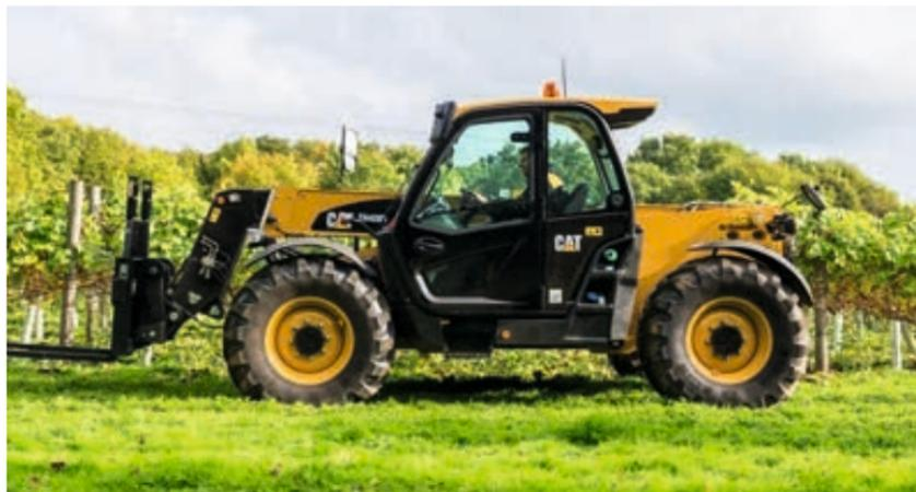
Die Typen TH357 bis TH3510 mit LoF-Zulassung sind mit einem zweiteiligen Ausleger (TH3510 dreiteilig) ausgestattet und eignen sich besonders für Einsätze im Agrarbereich, dafür sind diese Geräte auch mit speziellen Ausrüstungen lieferbar.
