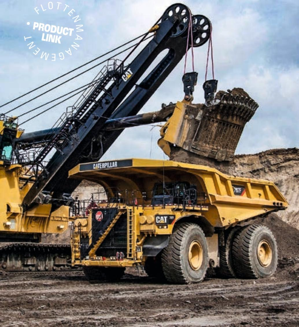
Die Cat Muldenkipper in der Nutzlastklasse 100 bis 400 Tonnen finden weltweit Einsatz beim Abbau von Rohstoffen im Berg- und Tagebau. Alle Typen sind mit robusten und sparsamen Cat Motoren ausgestattet, die zusammen mit vollautomatischen Getrieben und einem elektronisch gesteuerten Antriebsstrang mit Schlupfregelung jederzeit für kraftvollen Vortrieb und komfortable Schaltvorgänge sorgen.
