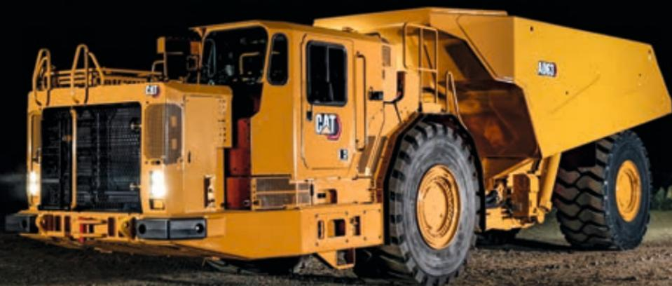
Die knickgelenkten Muldenkipper von Cat sind konsequent auf den harten, lang-jährigen Einsatz im untertägigen Bergbau ausgerichtet. Neben den Fahrzeugen mit Kipp-Mulde bieten wir auch für stark in der Höhe begrenzte Einsätze Ejektor-Lösungen an. Die robusten Muldenkipper zeichnen sich durch moderne, emissionsarme Antriebskomponenten, sehr gute Wartungsfreundlichkeit und hohen Bedienungskomfort aus.
