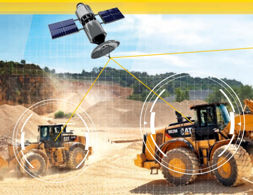
Für 45000 Cat Maschinen lag der durchschnittliche Leerlaufanteil 2021 bei 30 %. Einer der größten Kostenblöcke neben Anschaffungs- und Lohnkosten ist der Dieselmotorkraftstoff. Der einfachste Weg den Kraftstoffverbrauch nachhaltig zu senken, ist die konsequente Reduzierung des vermeidbaren Leerlaufes. Unser Flottenmanagement macht es möglich.
