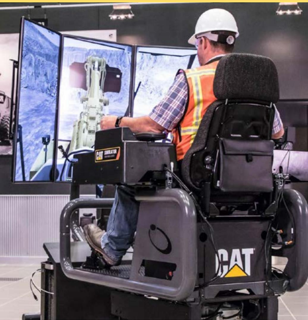
Die Simulatoren des weltweit einzigen durch Cat zertifizierten Herstellers simulieren verschiedene Cat Baumaschinenmodelle. Die originale Cat Steuerung erlaubt dem Fahrer den Umgang und das Bedienen verschiedener Maschinen zu trainieren. Ohne dafür eine echte Maschine nutzen zu müssen, können Sicherheitstrainings durchgeführt werden und Fahrer an neuen Maschinentypen geschult werden.
