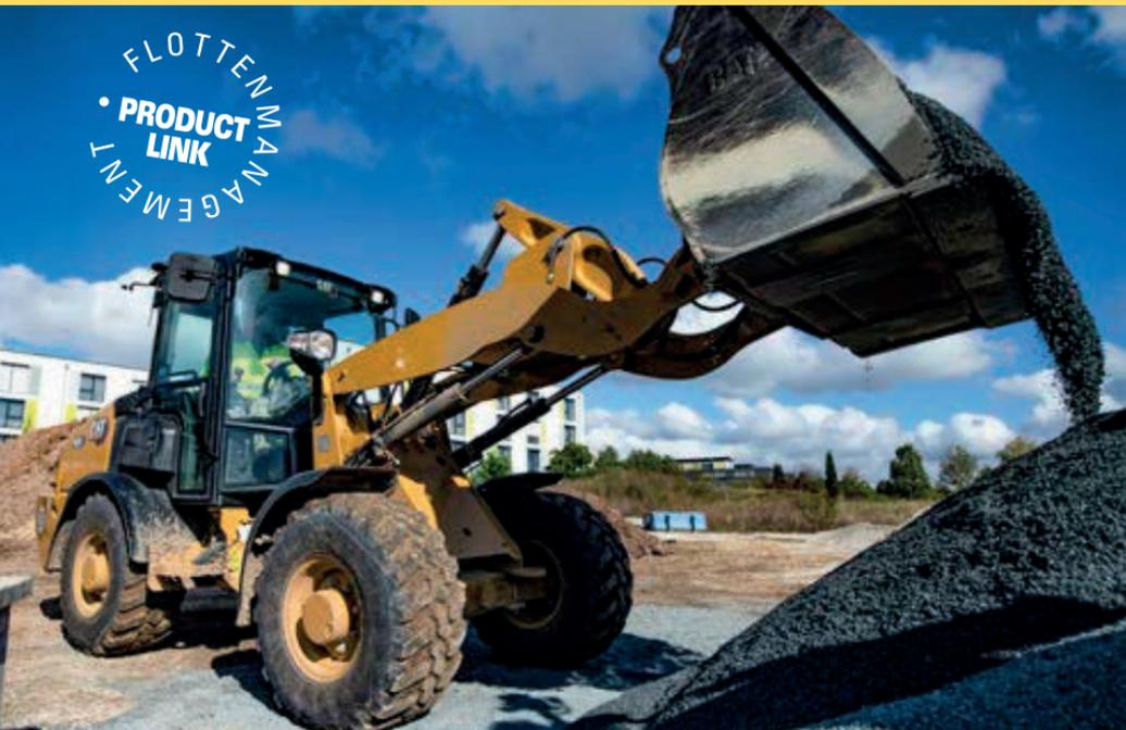
Die neue Generation der kompakten, leistungsstarken Cat Radlader mit hydrostatischem Antrieb mit zuschaltbaren Differentialsperren, Knickpendelgelenk und kräftiger Z-Ladekinematik zeichnet sich aus durch einen neuen Antriebsmotor, eine neu gestaltete Kabine und zahlreiche Weiterentwicklungen im Detail.
