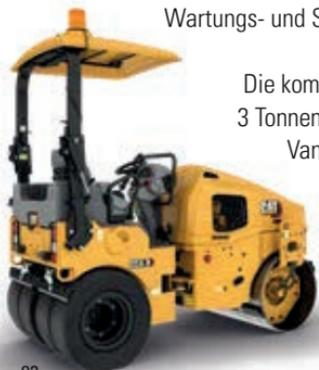
Die kompakten Cat Tandem-Vibrationswalzen in der Klasse ab 3 Tonnen sind serienmäßig mit umklappbarem ROPS-Bügel, Vandalismusschutz, Druckberieselung, Beleuchtung, hochwertiger Elektrik, Komfortsitz und 1-Schlüssel-System ausgestattet. Auf dem optional seitlich verschiebbaren Fahrersitz arbeitet der Fahrer noch präziser mit der Bandagenkante.
