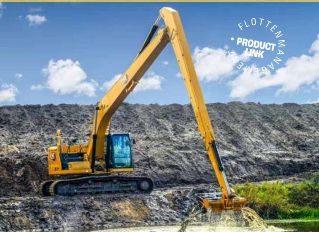
Mit speziellen Auslegern und Stielen sind diese Bagger vor allem für Wasserbau- und Böschungsarbeiten ausgerüstet. Diese Maschinen sind serienmäßig auch für Arbeiten unter Wasser in einigen Meter Tiefe ausgelegt, für große Wassertiefen bis 20 Meter sind speziell abgedichtete Ausführungen lieferbar.
