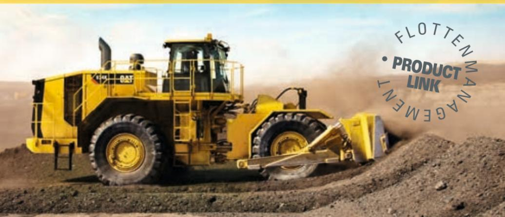
Mit optimiertem Antriebsstrang, verbesserter Fahrerkabine, verfeinertem Maschinenmanagement, mehr Sicherheit und Servicefreundlichkeit sind die Cat Raddozer besonders schnell und wendig. Mit sechs verfügbaren Schildkonfigurationen mit verschiedenen Schildkapazitäten können sie für Planier- oder Aufräumarbeiten individuell angepasst werden.
