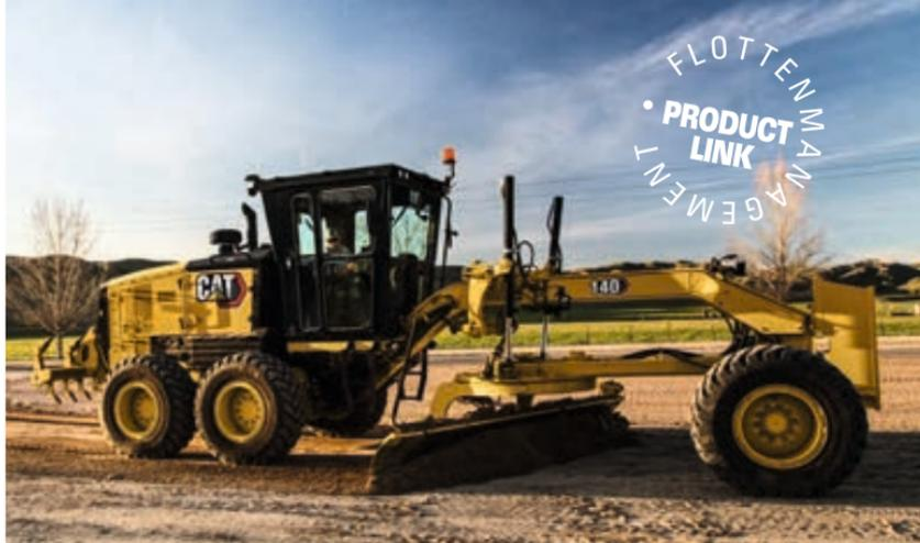
Bei allen Cat Gradern schaltet das elektronisch gesteuerte Getriebe schnell und sanft durch alle Gänge und bietet eine enorm hohe Schubkraft. Bis zum 160 sind alle Grader mit Allradantrieb verfügbar und können durch Frontschild und weitere Optionen an jeden Einsatz angepasst werden. Für hohe Flexibilität können verschiedene Typen für den Straßenverkehr zugelassen werden.
