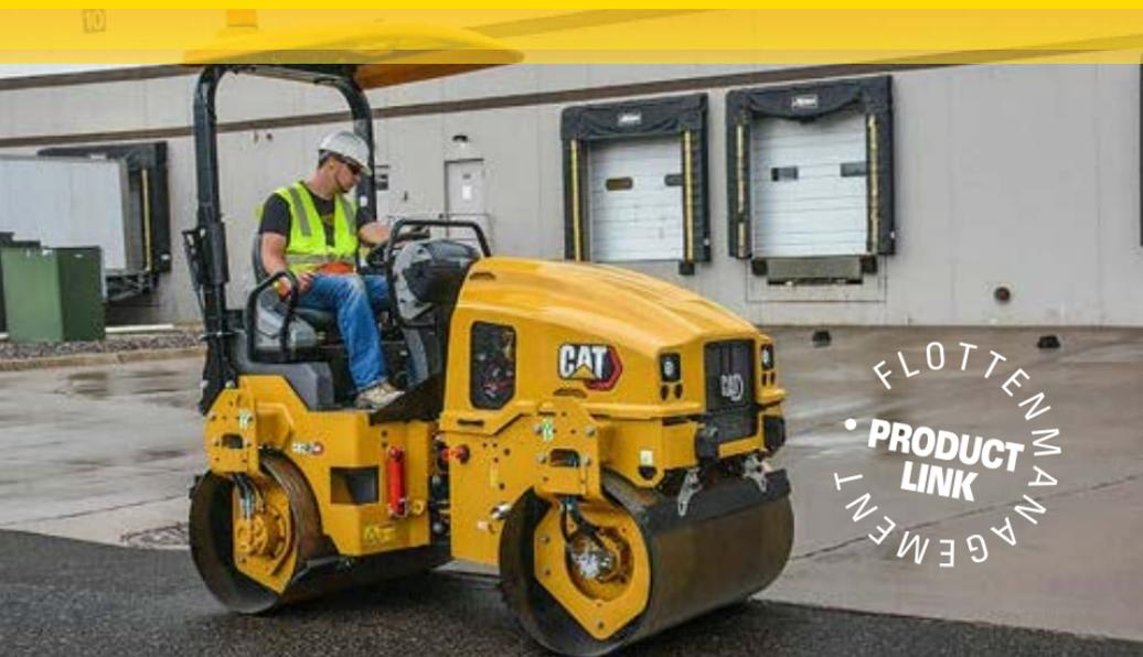
Die Typen in der Klasse 1 bis 4 Tonnen mit verbrauchsoptimiertem Cat Motor sind besonders robuste und vielseitige Maschinen, die sowohl bei Asphaltreparaturen als auch auf größeren Flächen hohe Leistungsfähigkeit beweisen. Mit der zentralen Kranöse sind die Maschinen schnell und sicher zu verladen, der umklappbare ROPS-Bügel ermöglicht den Einsatz auch bei eingeschränkter Durchfahrts Höhe. Vorbildlich auch die hohe Wartungs- und Servicefreundlichkeit.
