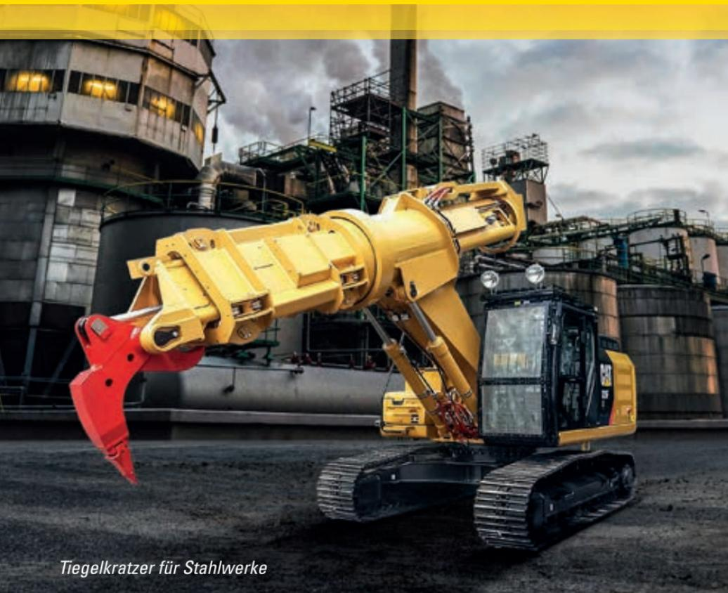
*Tiegelkratzer für Stahlwerke*
