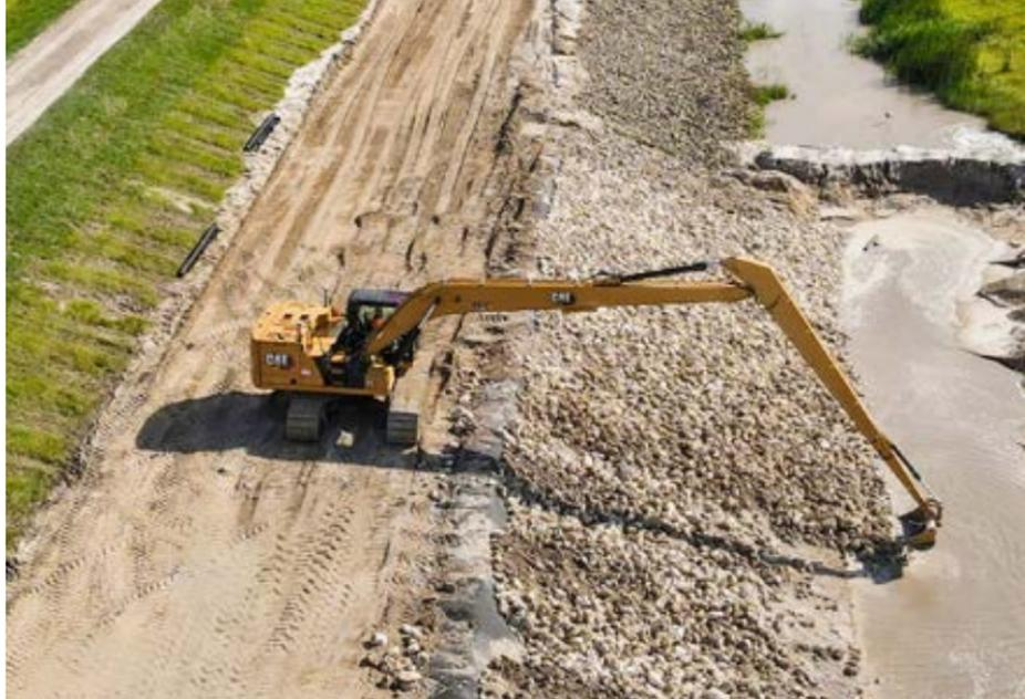
Die Cat Typen 330, 340 und 352 gibt es auch als LRE-Ausführung (Long Reach Excavation) mit etwas kürzerer Arbeitsausrüstung und mehr Kontergewicht, aber erweiterten Einsatzmöglichkeiten für Anbaugeräte und immer noch rund 66 Prozent Grabkraft im Vergleich mit der Standardmaschine.
