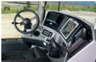
Caterpillar bietet für Schürfüge der Baureihe K drei neue Technologieoptionen. Die Folgesteuerung (Sequence Assist) speichert typische Ladeeinstellungen und erleichtert so dem Fahrer das Schürfen und Abladen. Die Ladesteuerung (Load Assist) ermöglicht die automatische Beladung des Kübels mit nur einem Tastendruck und verhilft
