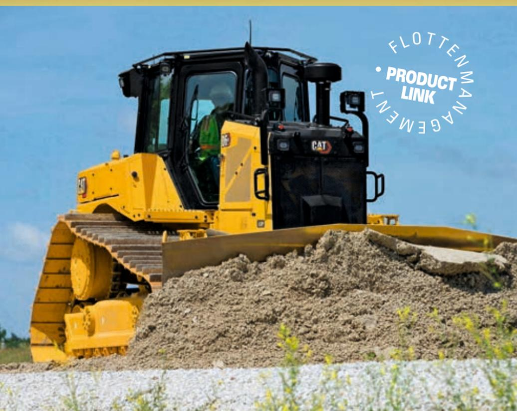
Mit dieselektrischer Antriebstechnik ist es Caterpillar gelungen, einen Dozer mit noch mehr Schubkraft und gleichzeitig feinstem Manövrierverhalten zu schaffen, der zudem noch sparsamer mit Kraftstoff umgeht. Mit dem D6 XE präsentierte Cat einen ganz neu entwickelten Dozer, bei dem das beliebte Deltalaufwerk mit hochgesetztem Turas erstmals mit einem starken Elektromotor angetrieben wird.
