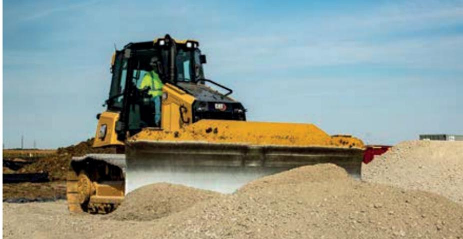
Alle Typen sind mit sparsamen Cat Motoren (Stufe V) ausgestattet, die besonders im Eco-Mode mit bis zu 10 Prozent weniger Kraftstoff auskommen. Die Traktionskontrolle erhöht die Effizienz und reduziert den Laufwerksverschleiß. Der bedarfsgesteuerte Lüfter ermöglicht weitere Verbrauchs- und Lärmreduzierung.
