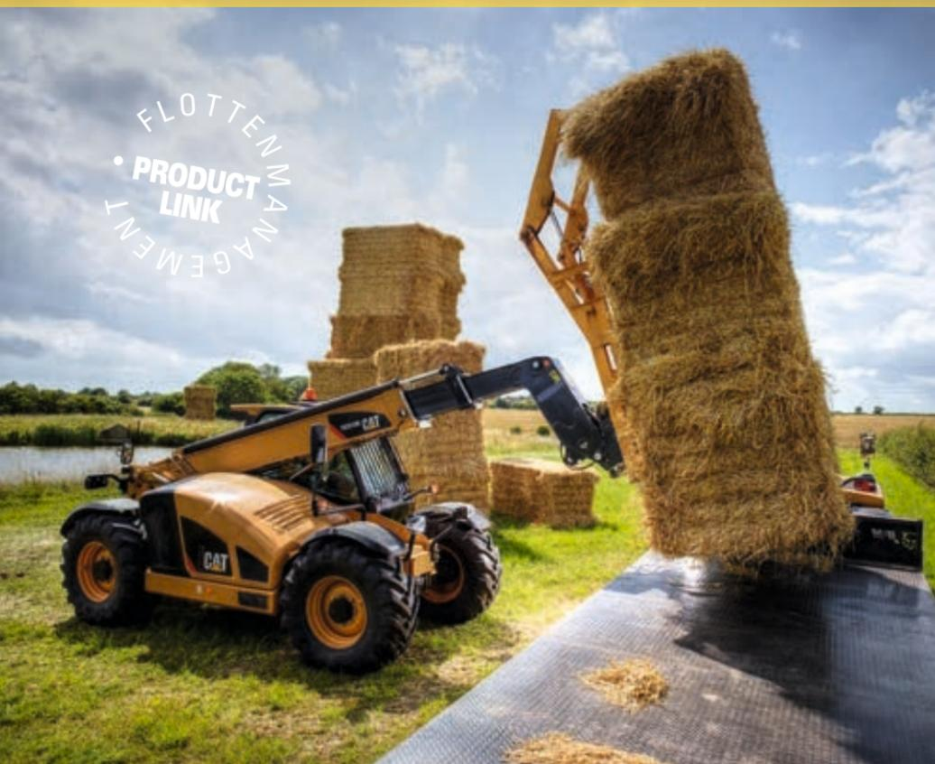
Cat Telehandler sind mit Allradlenkung und Allradantrieb besonders wendig und geländegängig. Mit Parallelhub und der großen Hubhöhe und Reichweite eignen sich diese Maschinen für viele Lade- und Stapelarbeiten sowie für den universellen Einsatz in der Landwirtschaft. Zahlreiche Anbaugeräte, wie Ballenklammer oder Kranlasthaken machen sie zu leistungsstarken Allroundern. Alle Telehandler sind mit abgasarmen und sparsamen Motoren der Stufe V ausgestattet.
