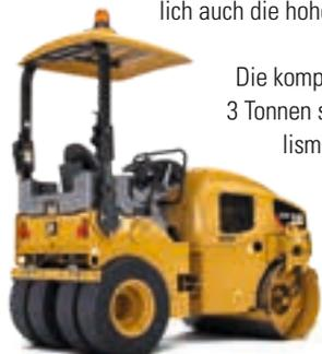
Die kompakten Cat Tandem-Vibrationswalzen in der Klasse ab 3 Tonnen sind serienmäßig mit umklappbarem ROPS-Bügel, Vandalismusschutz, Druckberieselung, Beleuchtung, hochwertiger Elektrik, Komfortsitz und 1-Schlüssel-System ausgestattet. Auf dem optional seitlich verschiebbaren Fahrersitz arbeitet der Fahrer noch präziser mit der Bandagenkante.
