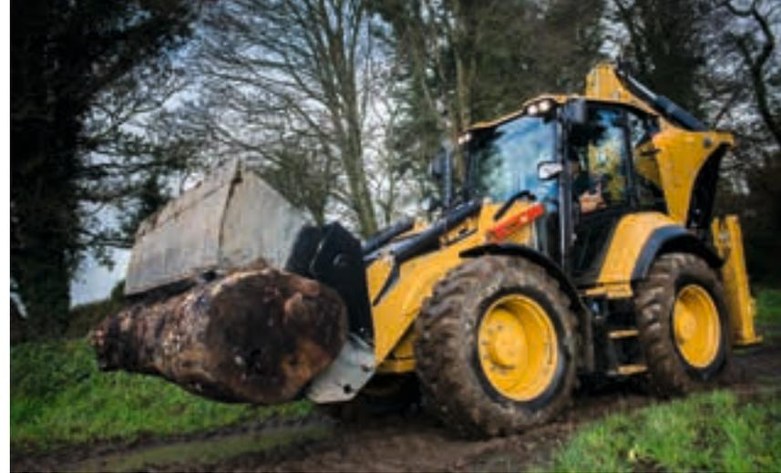
Zur Ausrüstung gehören eine leistungsstarke Load-Sensing-Hydraulik für hohe Arbeitskräfte, der optionale hydraulische Heckbaggerseitenverschub und der serienmäßige Zwei-Wege-Hydraulikkreis. Ausleger und Stiel sind besonders wartungsarm und die Komfortkabine bietet ausgezeichnete Rundumsicht.
