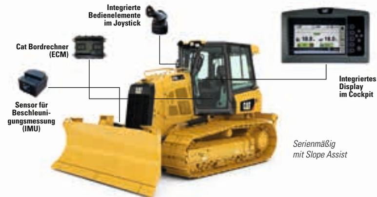
Alle Typen sind mit Stufe-IV-Motoren von Cat mit Harnstoffeinspritzung (D6K2 zusätzlich mit Partikelfilter) ausgestattet, die besonders im Eco-Mode mit wenig Kraftstoff auskommen. Die Traktionskontrolle erhöht die Effizienz und reduziert den Laufwerkverschleiß. Der bedarfsgesteuerte Lüfter ermöglicht weitere Verbrauchs- und Lärmreduzierung.
