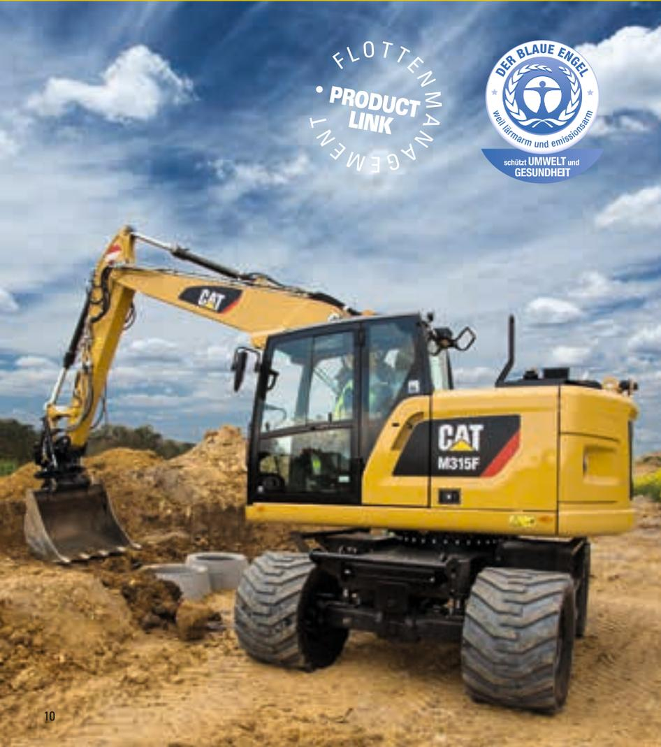
Mehr Sicherheit, mehr Komfort und weniger Verbrauch sind die wesentlichen Merkmale der Mobilbagger der Serie F. Die Cat ACERT-Motoren mit Partikelfilter (nicht M314F und M316F) und Harnstoffeinspritzung erfüllen Stufe IV und verbrauchen durch die einstellbare Leerlaufabschaltung, neue Eco-Modi und diverse Hydraulikverfeinerungen je nach Einsatz bis zu 10 % weniger Kraftstoff.
