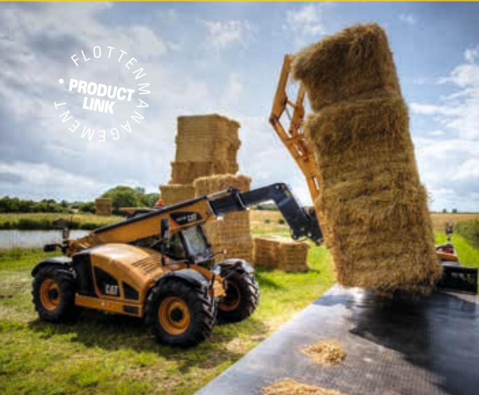
Cat Telehandler sind mit Allradlenkung und Allradantrieb besonders wendig und geländegängig. Mit Parallelhub und der großen Hubhöhe und Reichweite eignen sich diese Maschinen für viele Stapel- und Montagearbeiten sowie für den universellen Einsatz in der Landwirtschaft. Zahlreiche Anbaugeräte, wie Ballenklammer oder Kranlasthaken machen sie zu leistungsstarken Allroundern. Alle Telehandler sind mit abgasarmen und sparsamen Stufe-IV-Motoren ausgestattet.
