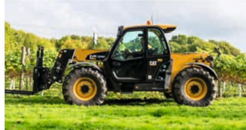
Die Typen TH357D bis TH3510D mit LoF-Zulassung sind mit einem zweiteiligen Ausleger (TH3510 dreiteilig) ausgestattet und eignen sich besonders für Einsätze im Agrarbereich, dafür sind diese Geräte auch mit speziellen Ausrüstungen lieferbar.
