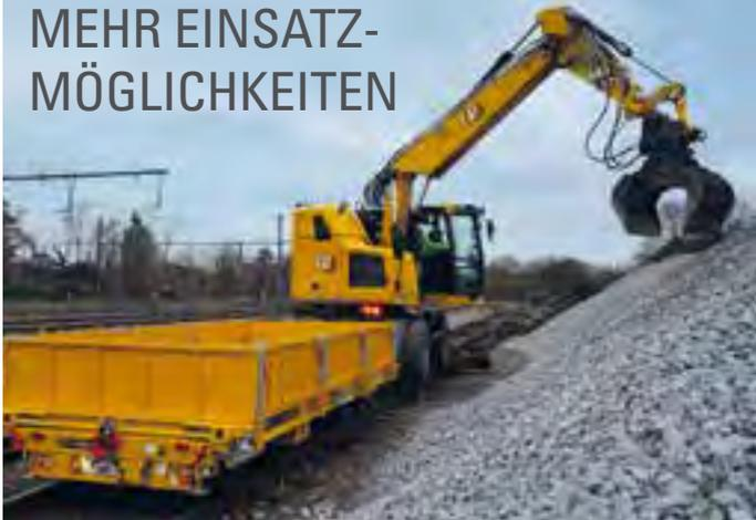
Auf Wunsch gibt es die Maschine mit einer Druckluftbrem- und Elektroanlage, um UIC-Waggons oder Trailer zu schleppen. Die hohe Zugkraft reicht aus für 220 t. Der 323F und die Waggons werden mit einer zertifizierten Zug-/Druckstange und einer automatischen Kupplung verbunden. Die neue Waggonbremsanlage und -steuerung bringt einen Zeitvorteil von bis zu 60 %.
