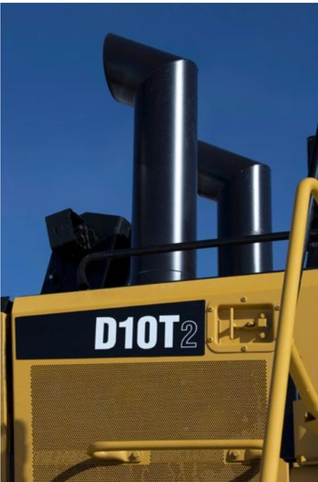
Der D10T2 ist mit zwei Ausführungen des Motors C27 mit ACERT-Konzept erhältlich. Die eine erfüllt die Emissionsnormen Tier 4 Final (USA) und ist für den Verkauf in Ländern mit strengeren Vorschriften erforderlich. Die andere Ausführung erfüllt die Normen Tier 2 und Stufe II für nicht oder weniger streng regulierte Länder.
