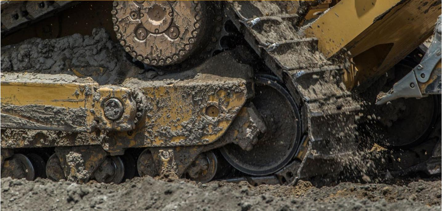
Das Delta-Laufwerk und die Aufhängung erhöhen gemeinsam die Traktion und verschaffen dem Fahrer mehr Fahrkomfort. Es überträgt an den Anbaugeräten induzierte Stoßbelastungen auf den Hauptrahmen, sodass die Seitenantriebe, Achsen und Lenkungscomponenten vor hohen Belastungen geschützt werden. Dies steigert letztlich die Produktivität und die Lebensdauer der Komponenten.
