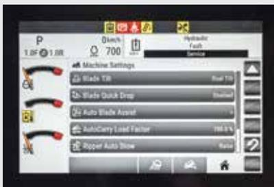
Die Funktion "Terrain mit Automatic Blade Control" integriert den vollautomatischen Schutz gegen volle Schildlast und übermäßigen Abtrag in der Steuerung der Dozer D11. Diese Tools beschleunigen die Arbeit, verringern den Kraftstoffverbrauch und minimieren zu starken Abtrag, Überfüllung und Umladung.
