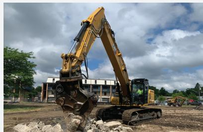
Optionale Zusatzhydraulikkreise bieten Ihnen die Vielseitigkeit, eine breite Palette an Cat-Abbruchanbaugeräten nutzen zu können, einschließlich Hydraulikhämmer, Scheren, Brecher, Pulverisierer, Greifer und mehr. Das 9 t schwere Kontergewicht sorgt auch bei Ausstattung mit den schwersten Anbaugeräten für Stabilität.
