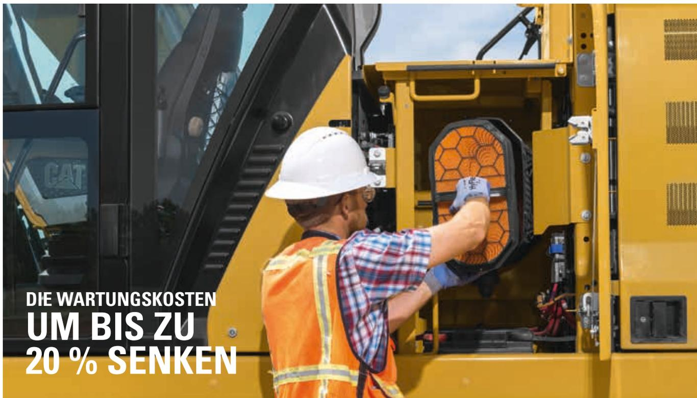
Weniger Wartungsteile in Kombination mit erweiterten und besser synchronisierten Wartungsintervallen erhöhen die Betriebszeiten und reduzieren Kosten. Die zusammengefassten Filterpositionen erleichtern die Wartung. Hydraulik-, Luft- und Kraftstofftank-Filter haben ein größeres Fassungsvermögen und halten länger. Der Zugriff auf das elektronische Bedienungs- und Wartungshandbuch erfolgt ganz einfach über den Monitor in der Kabine.
