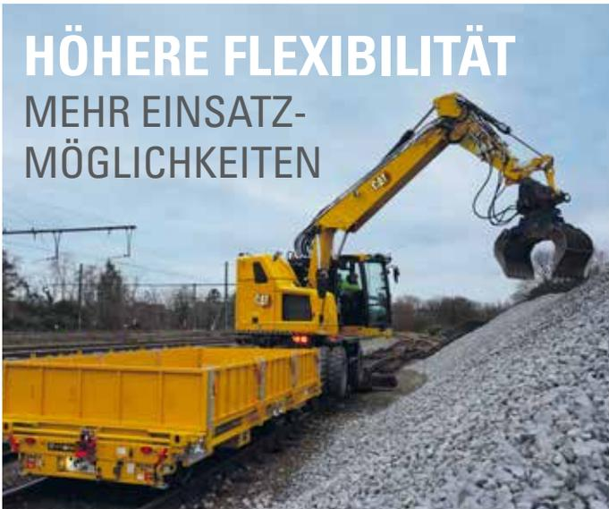
Auf Wunsch gibt es die Maschine mit einer Druckluftbrems- und Elektroanlage, um UIC-Waggons oder Trailer zu schleppen. Die hohe Zugkraft reicht aus für 220 t. Der 323F und die Waggons werden mit einer zertifizierten Zug-/Druckstange und einer automatischen Kupplung verbunden. Die neue Waggonbremsanlage und -steuerung bringt einen Zeitvorteil von bis zu 60 %.
