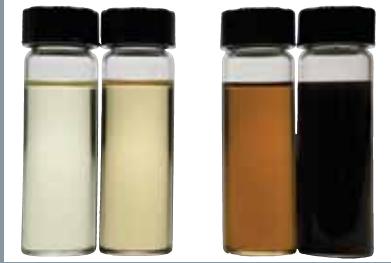
Öl zu Beginn Öl nach Einsatzprüfung
