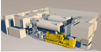
Netzersatzanlage als Gebäudeeinbau
